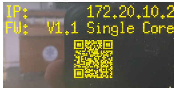
Abbildung 7.11: Fenster Information des PVMS
